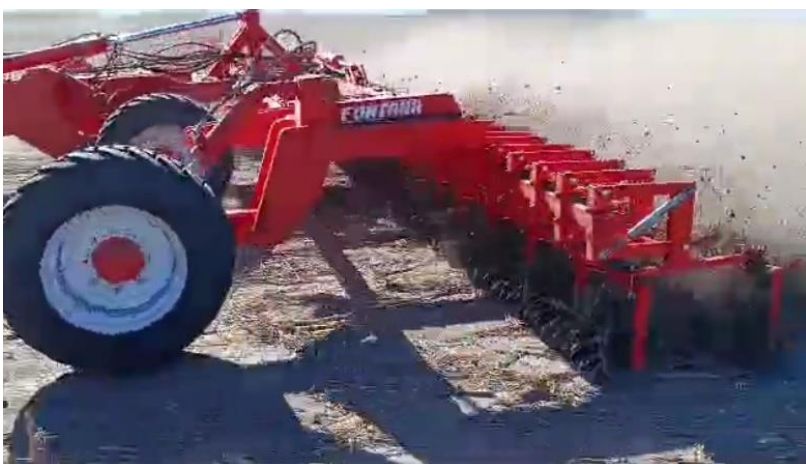
♦ Lote con sectores planchados y acción mecánica para la destrucción de la estructura laminar, en el centro norte del departamento General Obligado.
